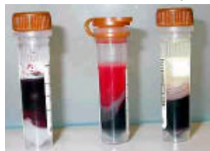
1. Unpun Gel 2. Partial spun Gel 3. Complete spun Gel
